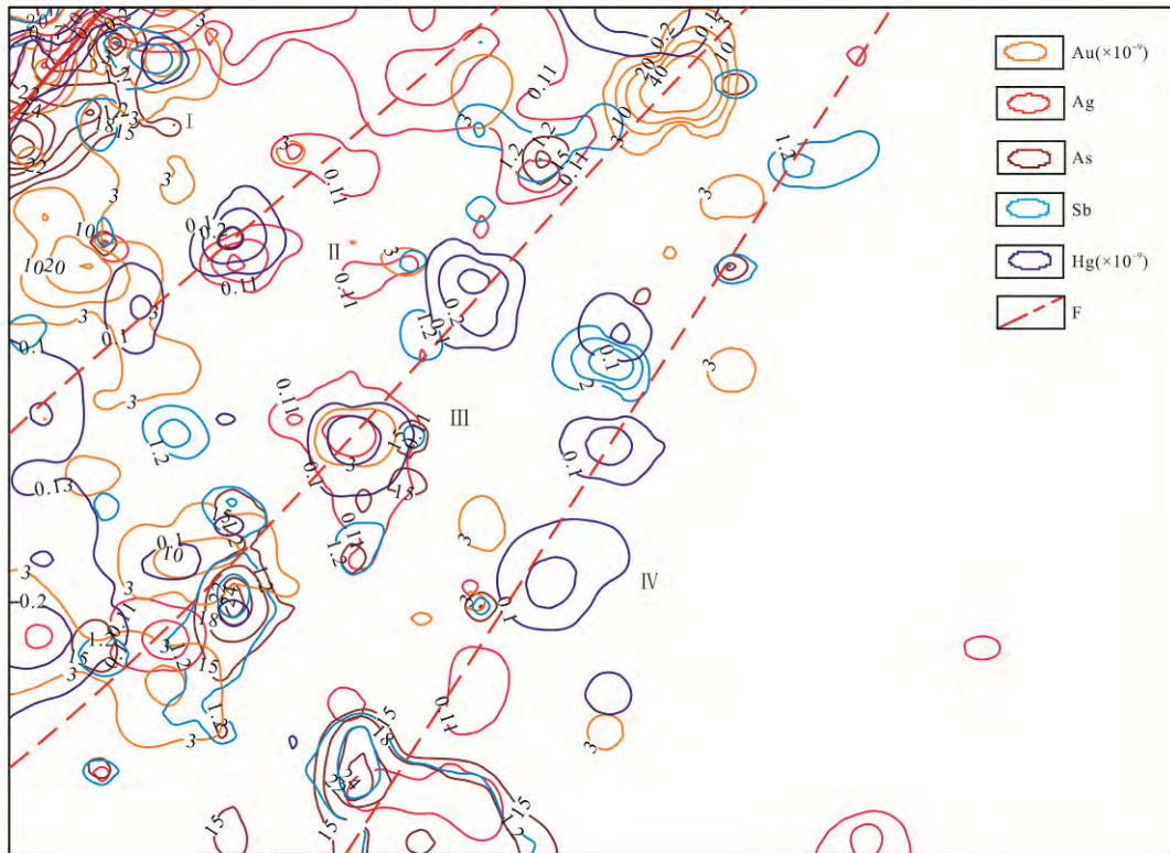
图 8 矿田不同片区 Au、Ag、As、Sb、Hg 元素地球化学综合异常图 Fig.8 Geochemical anomaly maps of different work areas in the orefield
